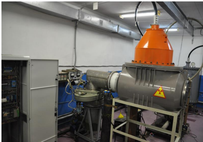
Рис.4 – Ускоритель «ДУЭТ»: 1-колпак изолятора; 2-высоковольтный кабель; 3- изолятор; 4-полый анод; 5-корпус плазменного катода; 6-катодный узел; 7-выпускное фольговое окно; 8-маска; 9-вакуумная камера.
