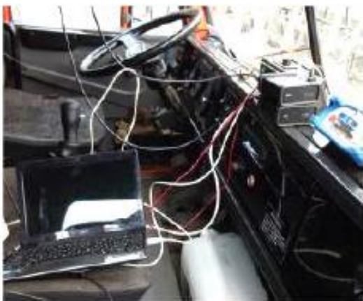
Оборудование, размещенное в кабине исследуемого автомобиля при замерах траекторий движения
