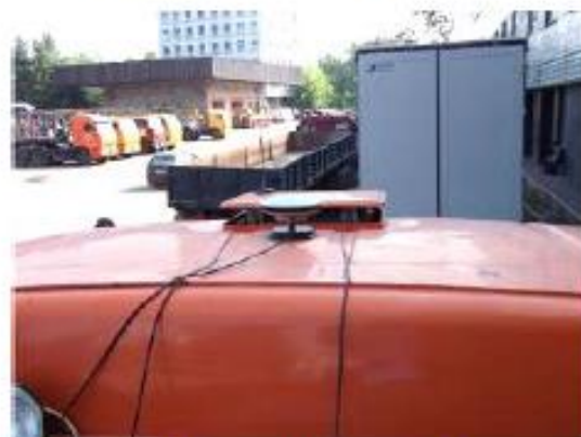
Оборудование, размещенное на крыше исследуемого автомобиля при замерах траекторий движения
