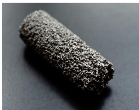
Пористый сплав никелида титана
