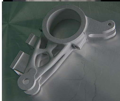
Рисунок 6 – Кронштейны для авиационной промышленности с облегченным дизайном из алюминиевого и титанового сплавов (AlSi10Mg и Ti4Al6V)
