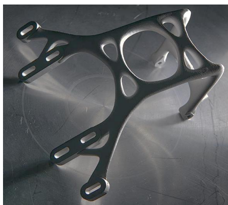
Рисунок 5 – Корпус опоры для перспективного двигателя семейства ВК, полученный селективным лазерным сплавлением
