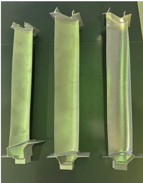
Рисунок 2 – Лопатка холодной части для перспективного турбореактивного двигателя семейства ПД (слева) и лопатки турбины высокого давления для перспективного двигателя семейства ПД из жаропрочного сплава, полученные селективным лазерным сплавлением из жаропрочного сплава
