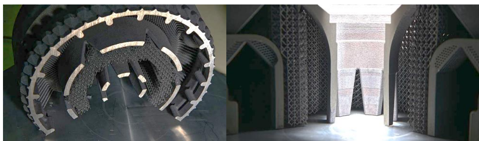
Рисунок 5 – Корпус опоры для перспективного двигателя семейства ВК, полученный селективным лазерным сплавлением
