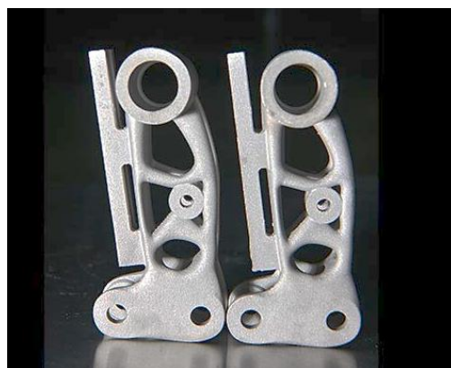
Рисунок 5 – Корпус опоры для перспективного двигателя семейства ВК, полученный селективным лазерным сплавлением
