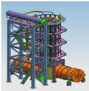
Энерготехнологический котла-утилизатор типа РКС
