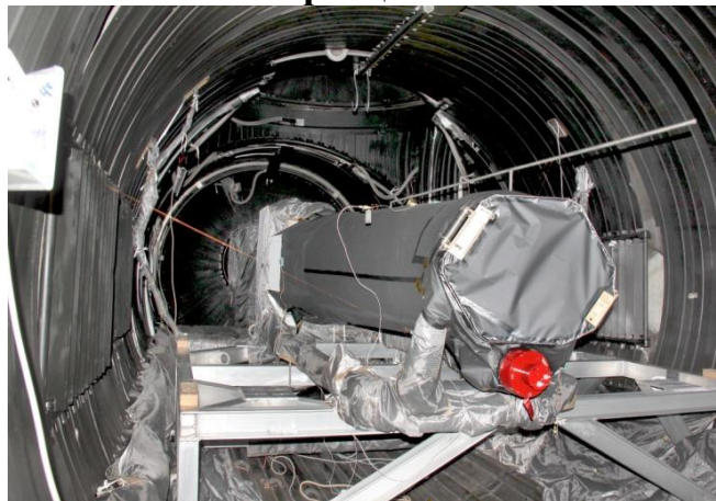
Термовакuumные испытания летного образца телескопа
