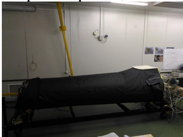
Окончательная сборка и установка черной неотражающей ЭВТИ
